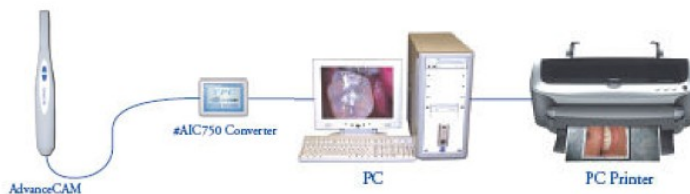
Podłączenie kamery przez złącze USB do komputera z drukarką
